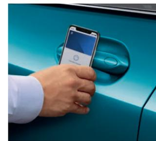
**L'Accès Confort** permet d'ouvrir les portes conducteur et passager et de démarrer le véhicule sur pression d'un bouton sans avoir à sortir la clé de la poche.
