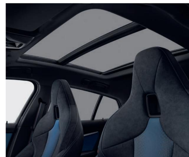
**Toit panoramique en verre électrique**, coulissant et entrebâillable à l'avant, avec pare-soleil, déflecteur et ouverture Confort via la clé radiocommandée.
