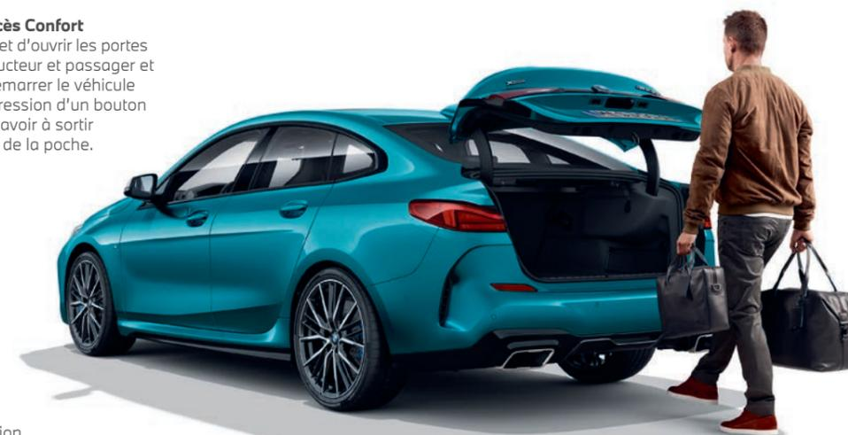
La fonction "**Smart Opener**" de l'option Accès Confort permet d'ouvrir le coffre en passant son pied sous le pare-choc.
