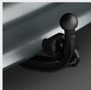
Le dispositif d'attelage avec rotule escamotable électriquement et système de stabilisation de l'attelage est homologué pour une charge tractée élevée pouvant atteindre jusqu'à 2 000 kg.
