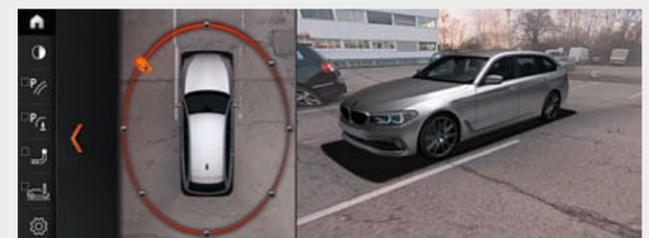
Le pack d'équipements « Parking Assistant Plus » facilite le stationnement de la voiture. Il comprend le système « Surround View » avec fonction « Top View », la vue 3D à distance, les radars de stationnement avant et arrière PDC actifs avec fonction de freinage d'urgence et une aide au stationnement latéral ainsi que le système de manœuvres entièrement automatiques « Park Assist » avec guidage latéral qui gare automatiquement la voiture en créneau ou en bataille.
