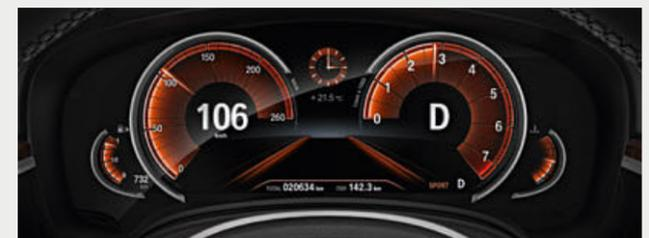
L'instrumentation « Black Panel » avancée avec diagonale d'écran de 12,3" (31,2 cm) offre une mise en scène visuelle impressionnante de l'expérience de conduite. Le système affiche au choix trois modes différents avec des couleurs et un graphisme spécifiques : ECO PRO, CONFORT et SPORT.
