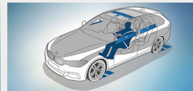
La **Protection active** des occupants est un système de sécurité préventif signé BMW ConnectedDrive. Elle prévient le conducteur en cas de fatigue ; dans les situations critiques, les ceintures de sécurité sont prétendues, le dossier des sièges à réglages électriques est redressé, les vitres et le toit ouvrant sont fermés. Après un accident, le système freine automatiquement la voiture jusqu'à l'arrêt.
