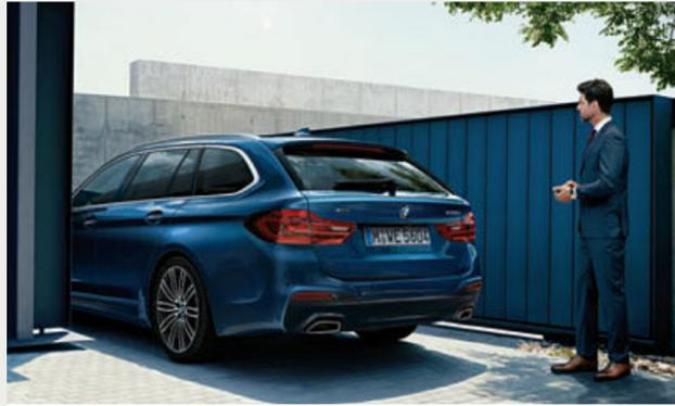
La fonction de Stationnement autonome télécommandé<sup>1,2</sup> permet au conducteur de sortir tranquillement de sa voiture, puis de garer celle-ci à distance en marche avant sur un emplacement ou dans un garage étroits ou de l'en sortir en marche arrière. Le conducteur active la fonction en dehors de la voiture par le biais de la clé intelligente « BMW Display Key ».
