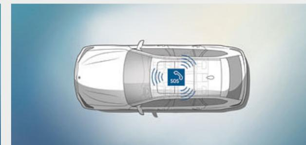
Si nécessaire, l'Appel d'Urgence **Intelligent établit** un contact automatique avec le centre de secours le plus proche via le Centre d'Appel BMW, et ce sans nécessiter la présence d'un téléphone portable personnel à bord de la voiture. Outre la position actuelle du véhicule, le système transmet également des informations sur la gravité de l'accident. L'Appel d'Urgence Intelligent peut aussi être déclenché manuellement, par exemple pour porter assistance à d'autres usagers de la route.
