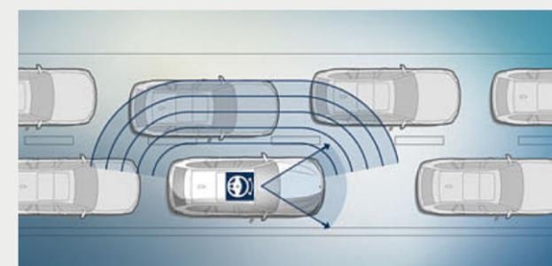
L'**Assistant de maintien**<sup>3</sup> de voie avec protection active des collisions latérales : par des actions correctives sur le volant, le système aide le conducteur à maintenir sa trajectoire, dans une plage de vitesses comprise entre 70 et 210 km/h, et contribue ainsi activement à prévenir d'éventuelles collisions latérales.
