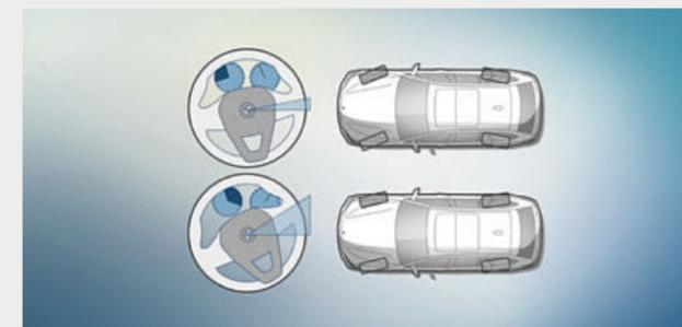
La direction **ActiveDrive** à 4 roues directrices associe une démultiplication asservie à l'angle de braquage sur l'essieu avant à des roues arrière directrices. À faible vitesse, ces dernières braquent dans le sens inverse des roues avant afin de garantir un surcroît de maniabilité et d'agilité. À partir d'environ 60 km/h, les roues arrière braquent dans le même sens que les roues avant pour augmenter la stabilité et le confort.
