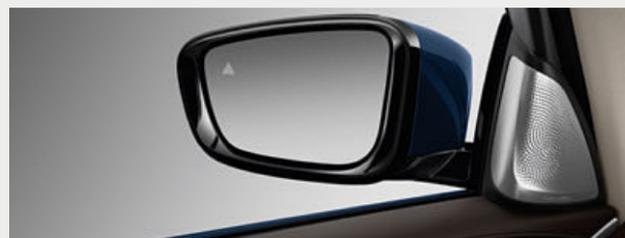
L'Avertisseur d'angle mort détecte la présence de véhicules dans l'angle mort et prévient le conducteur par le clignotement d'un voyant à LED sur les rétroviseurs extérieurs et des vibrations dans le volant (composant du pack Advanced Safety avec Pilote semi-automatique).
