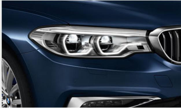
Le Pack Advanced Full LED intègre les feux de route permanents anti-éblouissement « BMW Selective Beam », l'éclairage d'intersection et les projecteurs directionnels. La lumière équivalente à celle du jour et l'éclairage optimal et homogène de la chaussée améliorent la visibilité et autorisent une conduite de nuit sans fatigue. Le design lumineux emblématique à quatre éléments rend la voiture reconnaissable en tant que BMW, même de nuit.
