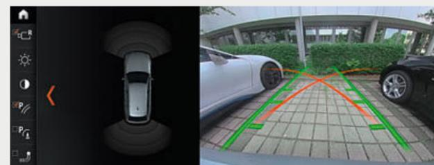
La caméra de recul garantit une meilleure orientation pour effectuer les marches arrière à moins de 15km/h, pour se garer par exemple. Elle affiche l'image de la zone située à l'arrière de la voiture sur l'écran de contrôle. Des lignes interactives indiquant la distance et le diamètre de braquage aident le conducteur lors des manœuvres de stationnement, au même titre que l'affichage en couleur des obstacles.
