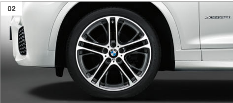
[ 01 / 03 ] La BMW X4 xDrive30d dans la teinte de carrosserie unie « Alpinweiss » représentée ici est équipée des jantes en alliage léger 19" (48 cm) style 622 M à rayons doubles avec monte pneumatique mixte. [ 02 ] Jantes en alliage léger 20" (51 cm) style 310 M à rayons doubles avec monte pneumatique mixte (optionnelles). Dimensions : 8,5 J x 20, à l'avant, pneumatiques 245/40 R 20 ; 10 J x 20 à l'arrière, pneumatiques 275/35 R 20. [ 04 ] Le volant M gainé cuir avec touches multifonctions offre une excellente prise en mains grâce à un profilage spécifique et à une jante plus épaisse. [ 05 ] Les sièges Advanced en cuir Nevada « Schwarz » (sellerie cuir optionnelle) pour le conducteur et le passager avant procurent un maintien latéral parfait et un confort exemplaire.
