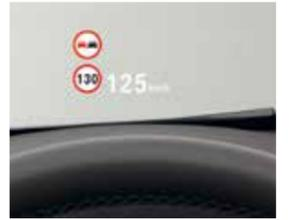
**Speed Limit Info** vous évite d'être pris en défaut dans votre conduite. Pour plus d'efficacité, l'affichage des limitations de vitesse et des interdictions de dépassement se fait à la fois sur le tableau de bord et dans l'affichage Tête Haute.
