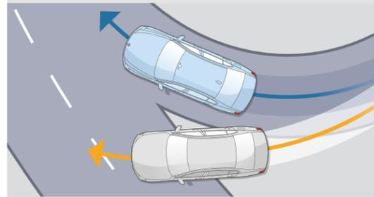
**Le Contrôle de la Transmission** intervient en courbe en transmettant davantage de couple aux roues extérieures au virage pour ralentir les roues intérieures. Résultat : une sécurité et un comportement dynamique améliorés.
