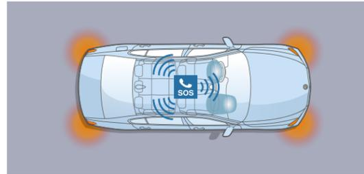
**L'Appel d'Urgence Intelligent** établit le contact avec le centre de secours le plus proche via le Centre d'Appel BMW, sans nécessiter un téléphone portable. Outre, le système transmet des informations sur la position du véhicule et la gravité de l'accident. Il peut aussi être déclenché manuellement, par exemple pour porter assistance à d'autres véhicules.
