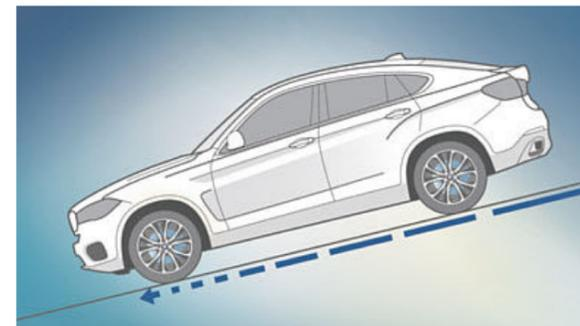
**Contrôle de motricité en descente HDC.** Ce système présent sur les modèles xDrive réduit automatiquement la vitesse de la BMW sur de fortes pentes sans que le conducteur ait à freiner.
