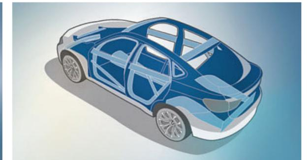
**Habitacle.** En cas de collision, il optimise la sécurité passive grâce à un système de traverses et de nœuds d'ossature ainsi qu'au recours ciblé à des matériaux ultra-résistants.
