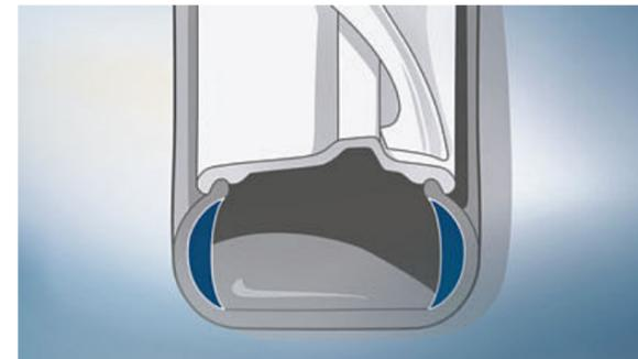
**Des capteurs mesurent la pression de chaque pneumatique.** La mesure individuelle de pression des pneumatiques avertit à temps le conducteur d'une perte de pression.
