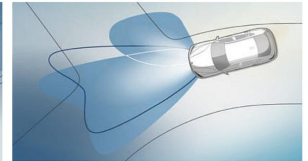
**Projecteurs directionnels** avec répartition variable de la lumière en ville comme sur autoroute, éclairage d'intersection pour un éclairage optimal de la chaussée et feux de route permanents anti-éblouissement « BMW Selective Beam ».
