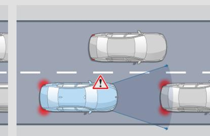
**Détection de collision avant avec freinage**
