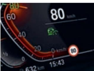
**Speed Limit Info** vous évite d'être pris en défaut dans votre conduite. Pour plus d'efficacité, l'affichage des limitations de vitesse et des interdictions de dépassement se fait à la fois sur le tableau de bord et dans l'affichage Tête Haute HUD en couleur.
