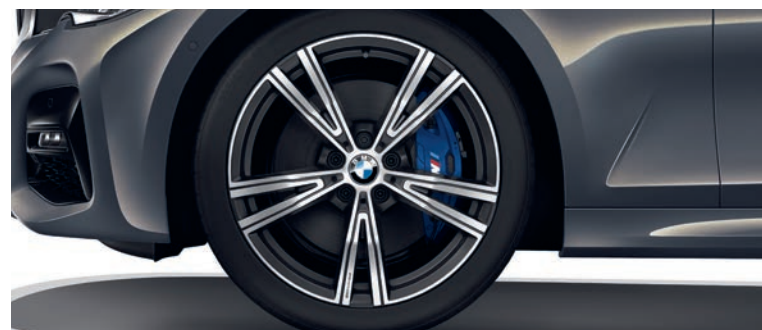
19" Jantes alliage léger BMW Individual style 793 bicolores Orbit Grey Pneumatiques : Avant : 225/40 R19 - Arrière : 255/35 R19
