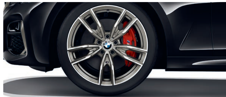
19" Jantes alliage léger M style 792 M bicolores Cerium Grey Pneumatiques : Avant : 225/40 R19 - Arrière : 255/35 R19
