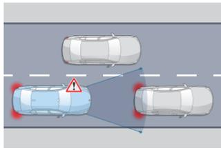
**Détection de collision avant avec freinage**
