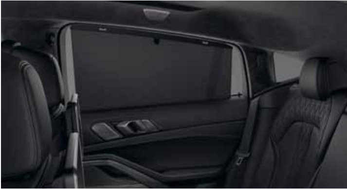
Les stores pare-soleil Pour les vitres latérales arrière, se déroulant et s'enroulant manuellement, ils protègent du soleil et des regards indiscrets.
