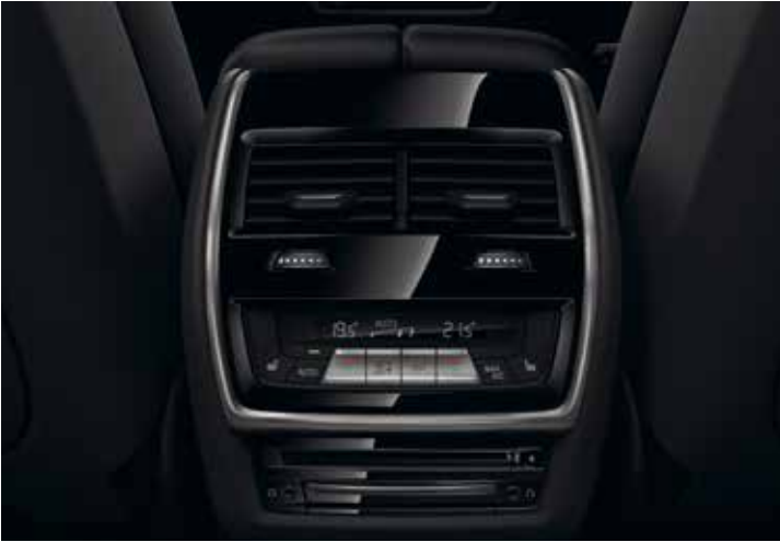
La climatisation automatique 4 zones inclut des fonctionnalités étendues en plus des fonctionnalités de la climatisation automatique 2 zones ainsi que deux aérateurs sur les montants centraux. Par ailleurs, les passagers arrière bénéficient d'un réglage individuel via une commande séparée avec affichage.
