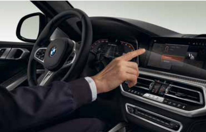
Commande gestuelle BMW Pour piloter certaines fonctions grâce à des mouvements précis de la main. Le système reconnaît ainsi les gestes "balayer" ou "montrer", qui permettent notamment d'accepter ou rejeter un appel entrant, ou encore de régler le volume sonore en effectuant un mouvement rotatif avec l'index.
